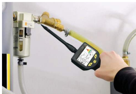
Leckageerkennung mit Richtrohr
