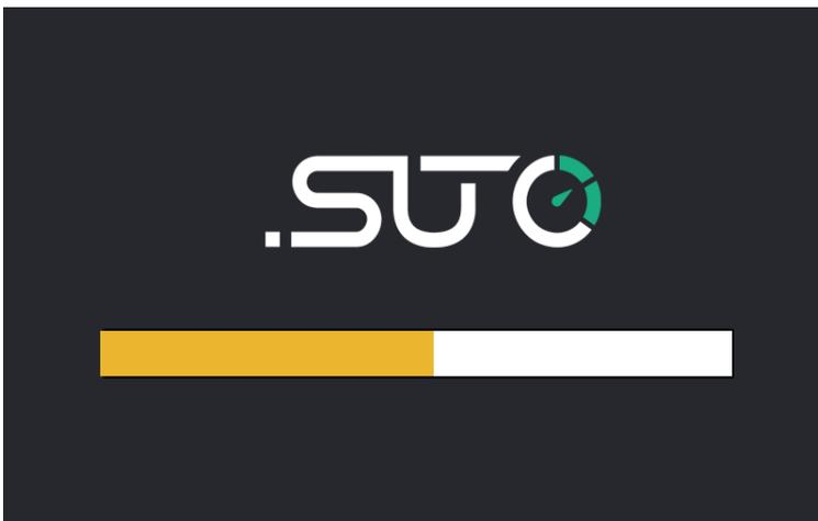
Wird das S600 eingeschaltet, erscheint der Startbildschirm. Der Balken zeigt den Fortschritt des Startvorgangs an. Während des starten werden die Sensoren initialisiert.
