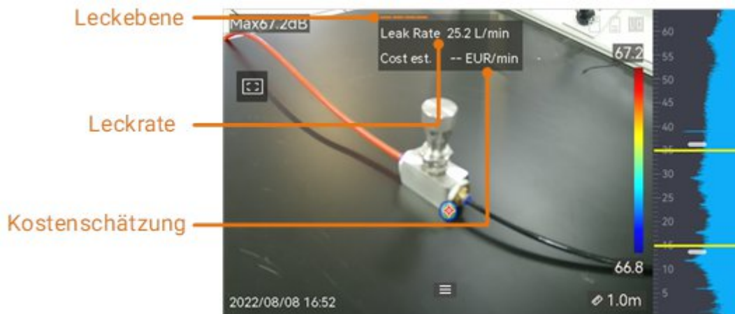
Schätzung einer Gasleckage
