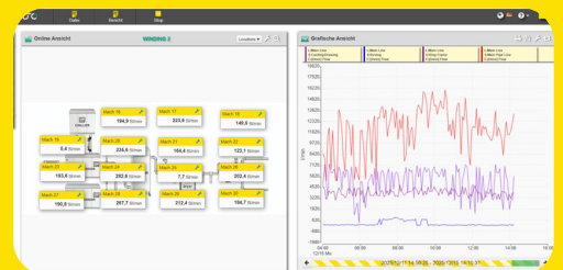
S4M -Dashboard zeigt Echtzeit-Durchfluss und Verbrauch einzelner Verbraucher für Vergleich und Berichte
